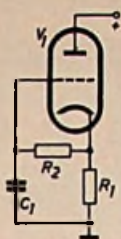
Abb. 1. Das Grundprinzip der im Zeitschalter angewendeten „Bootstrap“-Röhre zur Linearisierung der Ladekurve von C_1
